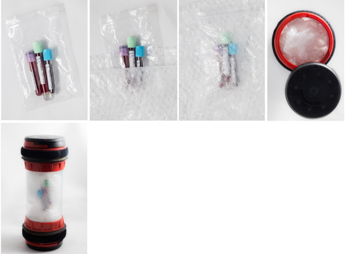
Abbildung 4: Manuelles Verpacken von diagnostischen Proben unter Verwendung von Luftpolsterfolie in der konventionellen Rohrpostkartusche (AD160 von Aerocom®)
