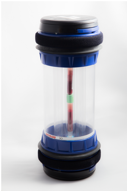
Abbildung 1: Blauer Prototyp mit transparenten, durchgehenden Innenrohren ohne Fixierungsmechanismus
