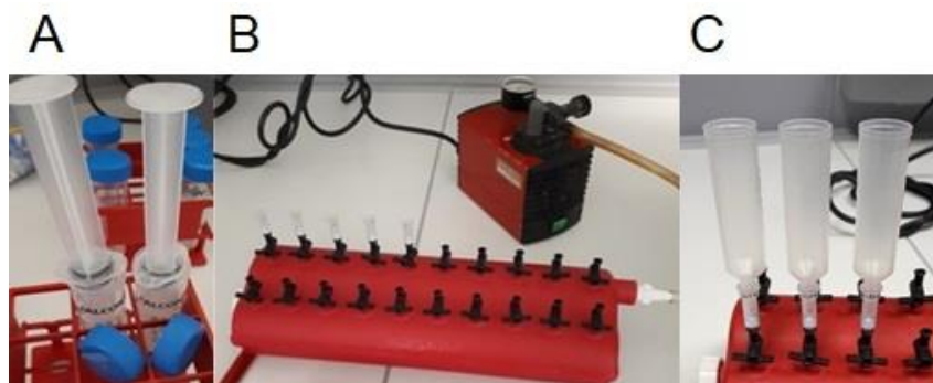
Abbildung 11: Versuchsaufbau Midi-Präp. A: QIAfilter cartridge , B: Biometra MP86 Membran Vakuumpumpe mit VM20 Vacuum Manifold, C: Aufbau des Säulenaufsatzes
