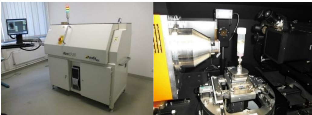
Abbildung 3.3: Mikrocomputertomograph XRadia XCT-200 X-Ray (links), Probenschlitten mit Objekthalter (rechts).
