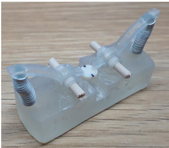
Abb. 9: Probenhalter mit eingespannter Probe, welche markiert wurde, um sie um 90° drehen zu können.
