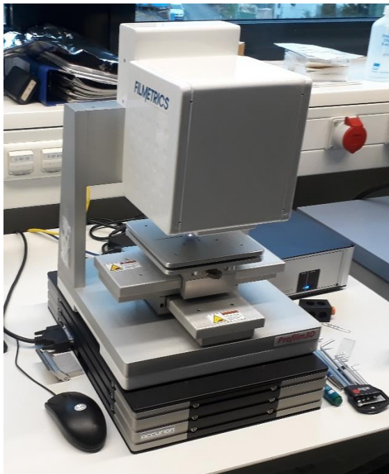
Abb. 2: Profilometer auf aktivem Schwingungsisolierungssystem
