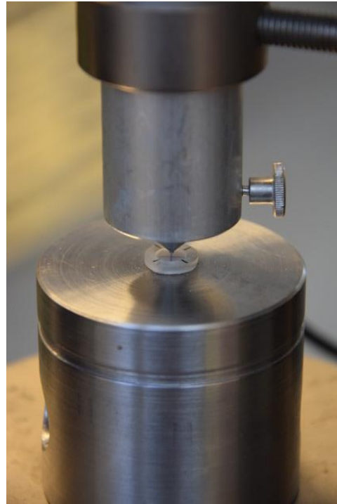
Abb. 12: Prüftisch mit Zentrierring und Probe
