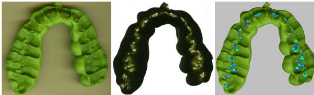
Abbildung 19: Darstellung eines Bissregistrates in Auflicht, Durchlicht sowie beider Bilder übereinander gelagert mit farblich markierten Kontaktpunkten
