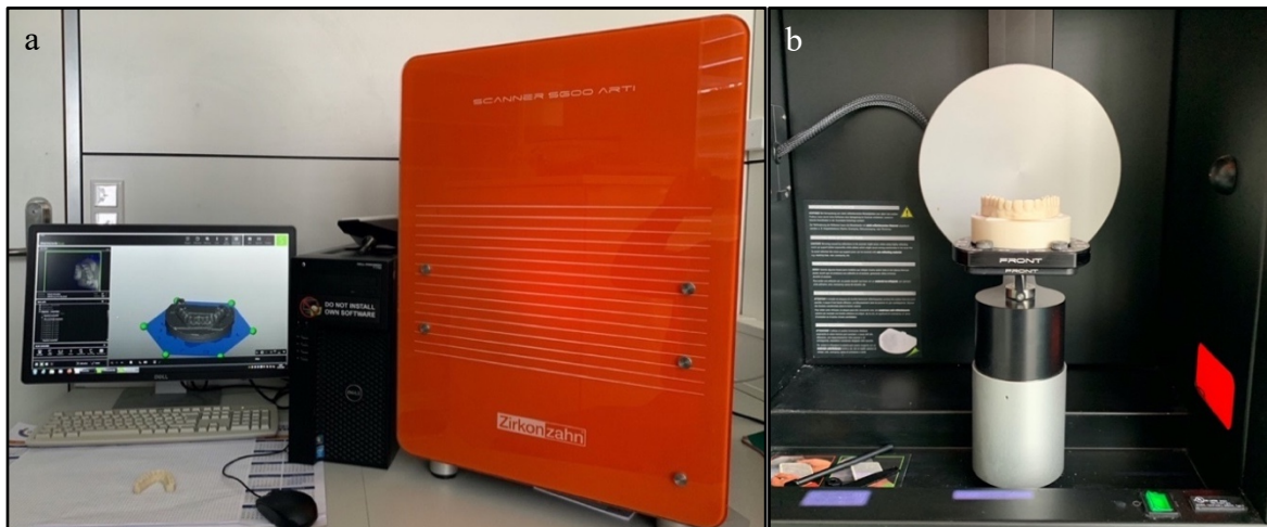
Abb. 18: Darstellung des Streifenlichtscanners Zirkonzahn AR600 ARTI mit geschlossener Scankabine und zugehörigem Computer mit geöffneter Scansoftware (a). Darstellung der Scankabine des Modellscanners mit dem auf der Scanplatte fixierten Zahnbogen (b).
