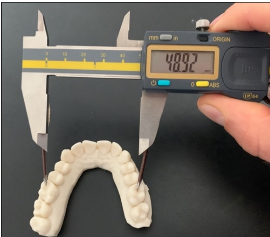
Abb. 20: Anwendungsdarstellung der manuellen Modellvermessung mittels digitaler Schieblehre (SKANTEK GmbH, Erlangen). Beispieldarstellung der Messung der hinteren Zahnbogenbreite am Oberkieferzahnbogen (hZBB0).
