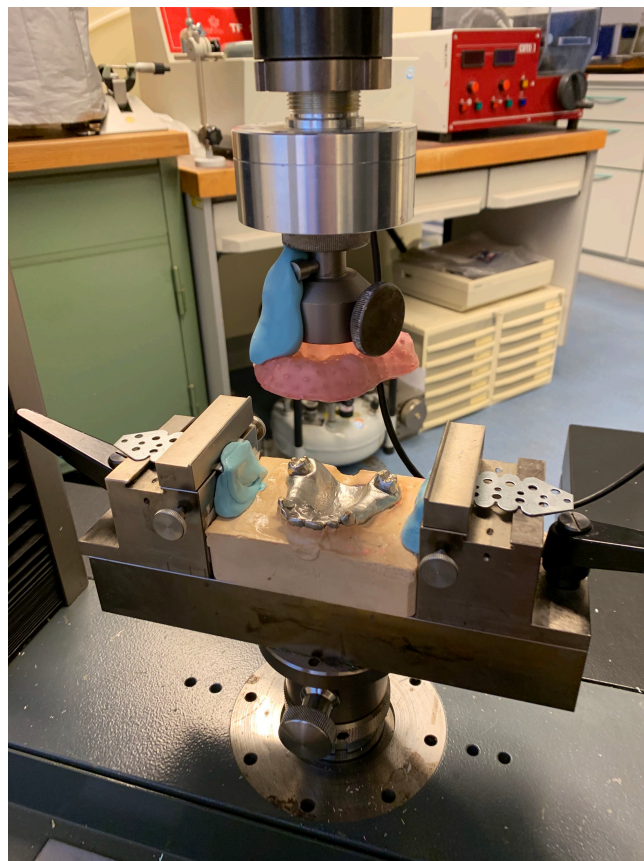
Abbildung 6: Meistermodell und befüllter Abformlöffel in der Material-Prüfmaschine (eigenes Bildmaterial)
