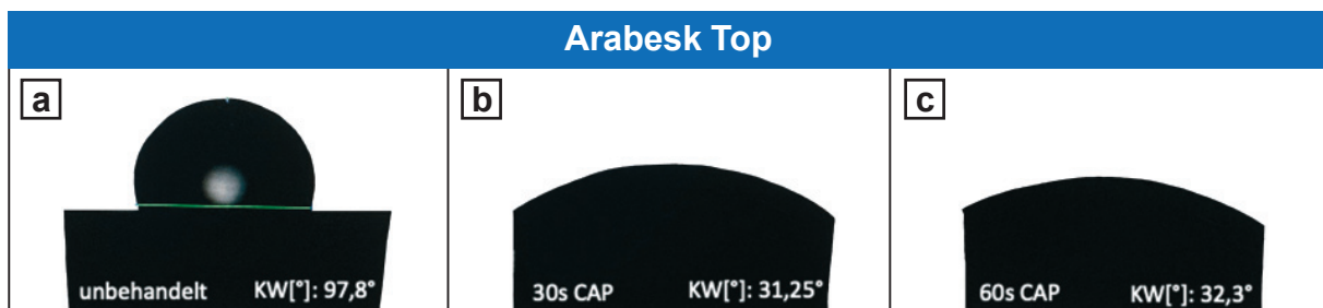
Abbildung 13: Foto des Tropfens Aqua Dest. auf der Arabesk Top Probenoberfläche während der Wasserkontaktwinkelmessung nach der Sessile Drop Methode:
