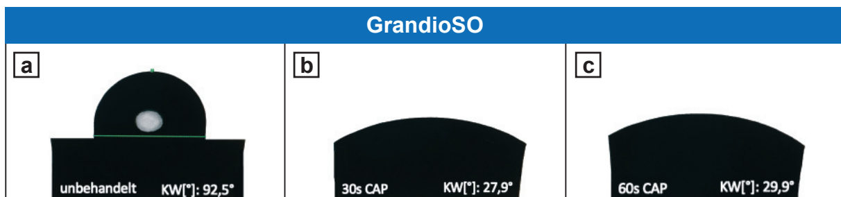
Abbildung 14: Foto des Tropfens Aqua Dest. auf der GrandioSO Probenoberfläche während der Wasserkontaktwinkelmessung nach der Sessile Drop Methode:
