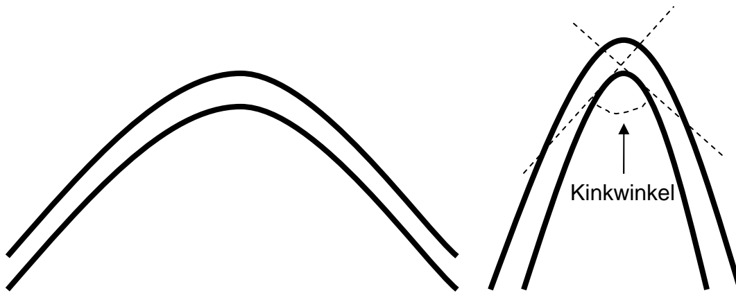
Abb. 3) Schematische Darstellung eines Kinkings. Links bogenförmiger Verlauf, rechts Kinking. Als Kinkwinkel wird der Winkel zwischen den beiden Tangenten bezeichnet. 23
