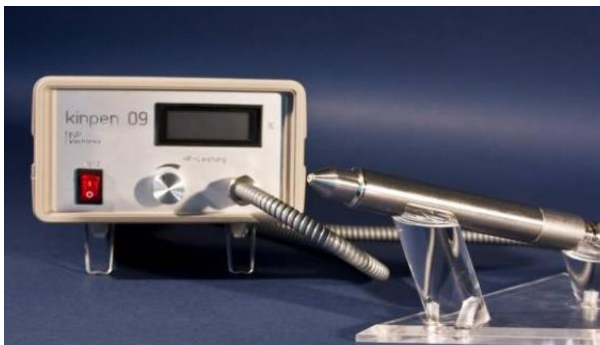
Abb. 4: Steuergerät und Handstück des kINPen09 ® (aus: http://www.plastep.eu )
