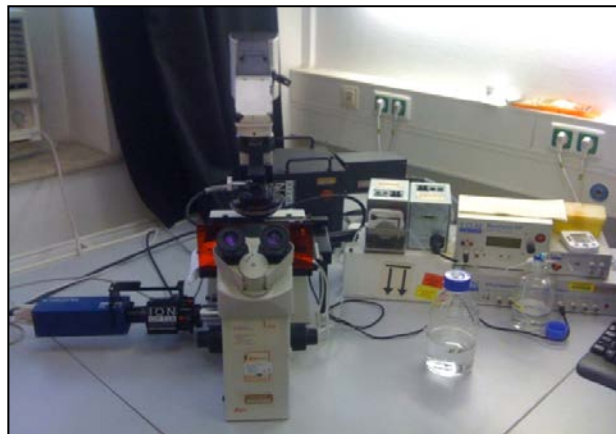
Abb. 2.2.1 Anlage bestehend aus einem inversen Fluoreszenzmikroskop mit angeschlossenem Kontraktions- und Calciumdetektionssystem. Simultane Messung der Fluoreszenz des \text{Ca}^{2+} -sensitiven Farbstoffes Fur-2 in den Kardiomyozyten mit dem Detektionssystem mit Hilfe des Fluorescence Interface (IonOptix, Milton, USA) bei 340 und 380nm Wellenlänge
