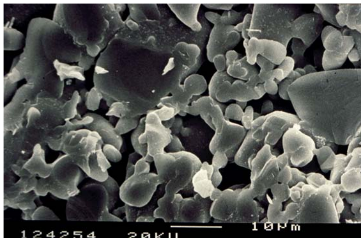
Abbildung 2: Dentalkeramik unter REM, Fa. Degudent, Rossbach
