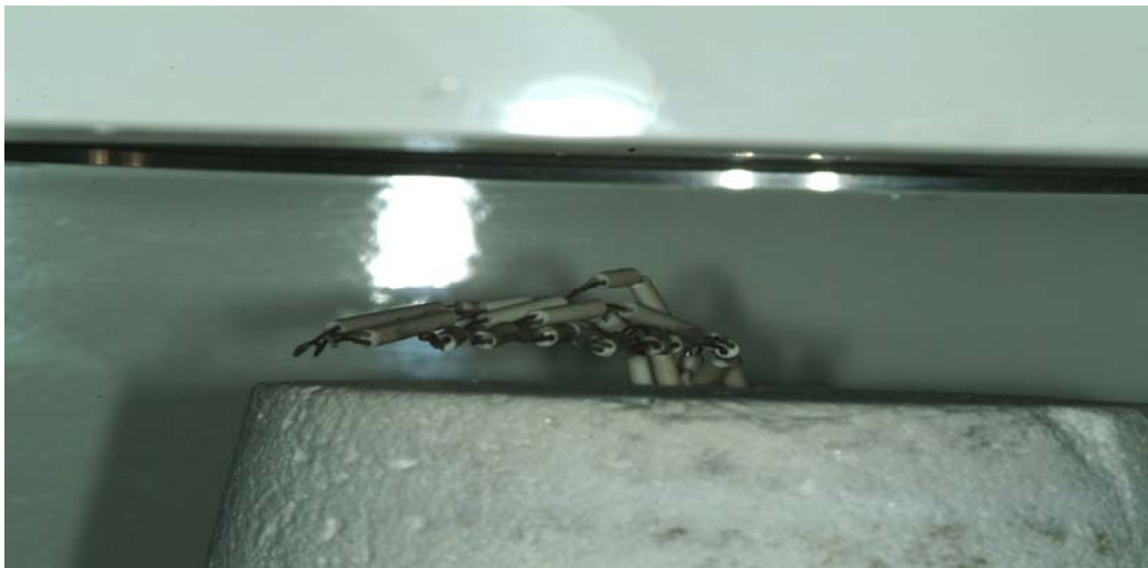
Abbildung 13: Positionierung der Thermosonden in der Brennkammer Austromat 3001 ® , Fa. Dekema, Freilassing
