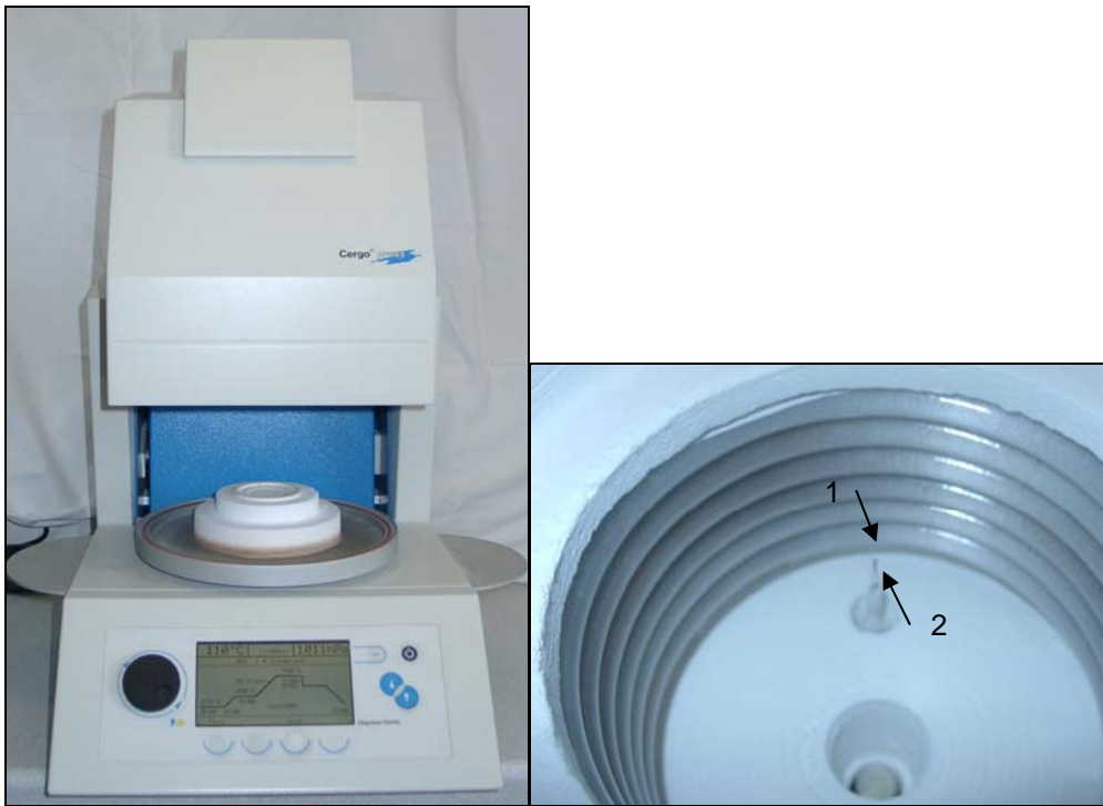
Abbildung 9 und 10: CergoPress ® , Fa. Degudent, Brennkammerausschnitt; (1), (2) Thermosonden der ofeninternen Steuerung
