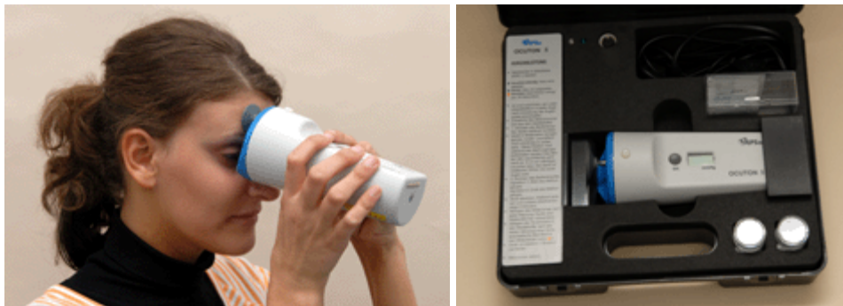
Abb. 1 Handhabung des Selbsttonometers „Ocuton S“ (links), Aufbewahrung im Koffer zur Desinfektion und elektrischen Ladung (rechts).
