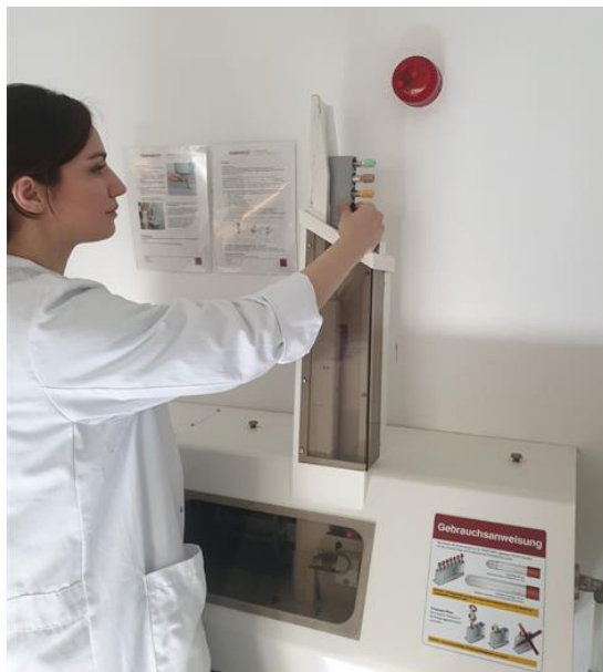
Abb. 3 Fahrstienen-Magazin a) Eingabe des Racks in das Magazin b) Gesamtansicht der Eingabestation
