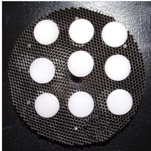
Abb. 10: Positionierung der Grünlinge auf dem Sinterträger (hier: Honeycomb-Thermo-Tray)
