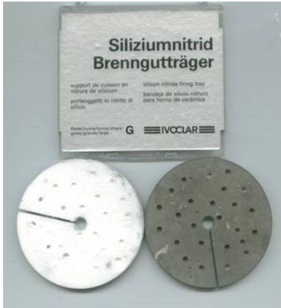
Abb. 7: Siliziumnitrid–Brenngutträger (Fa. Ivoclar, Schaan, Liechtenstein)
