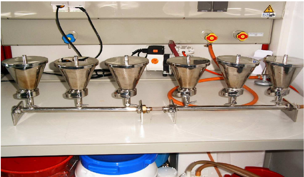
Abb.3 Vakuum-Filtriereinheit mit Dreifachabsaugvorrichtung je Einheit mit 500 ml Aufsätzen (SM 16828, Sartorius)
