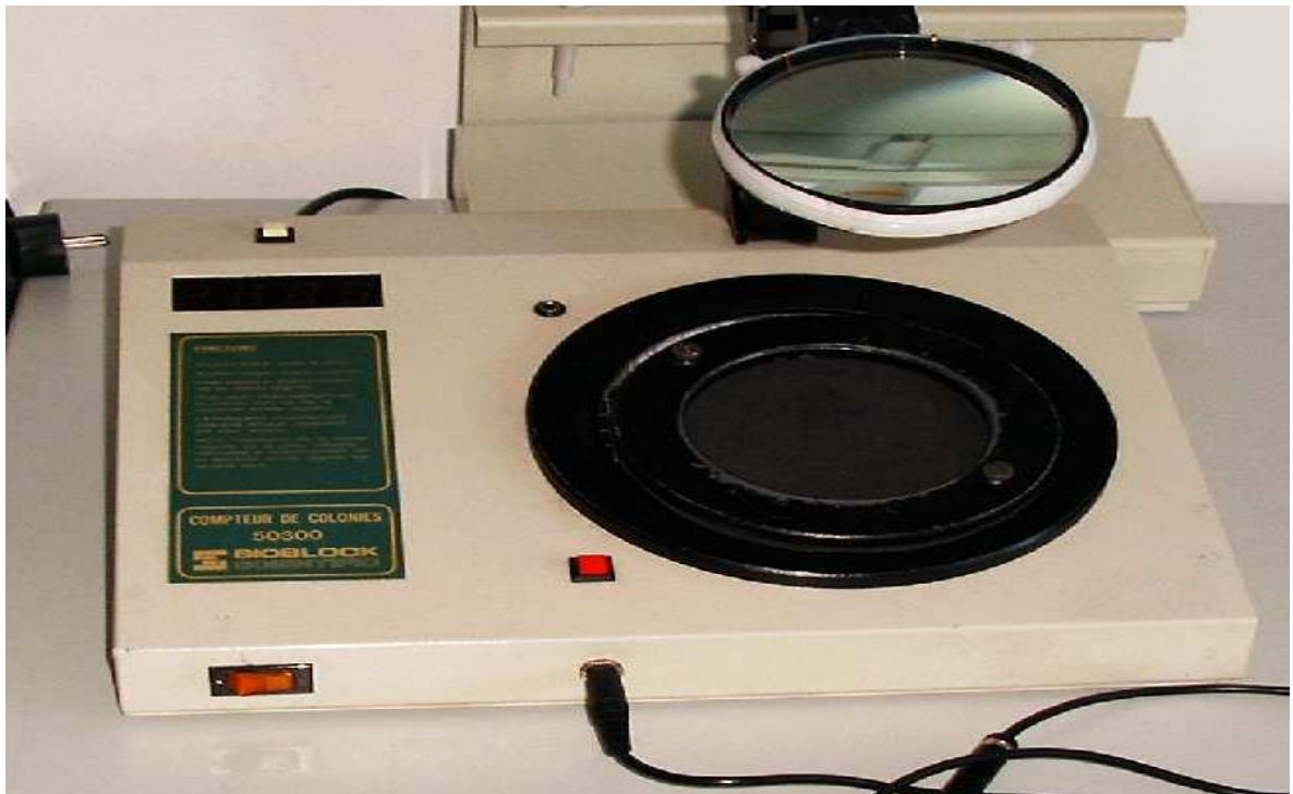
Abb.2 Zählgerät Compeur de Colonies 50300 (Bioblock Scientific)
